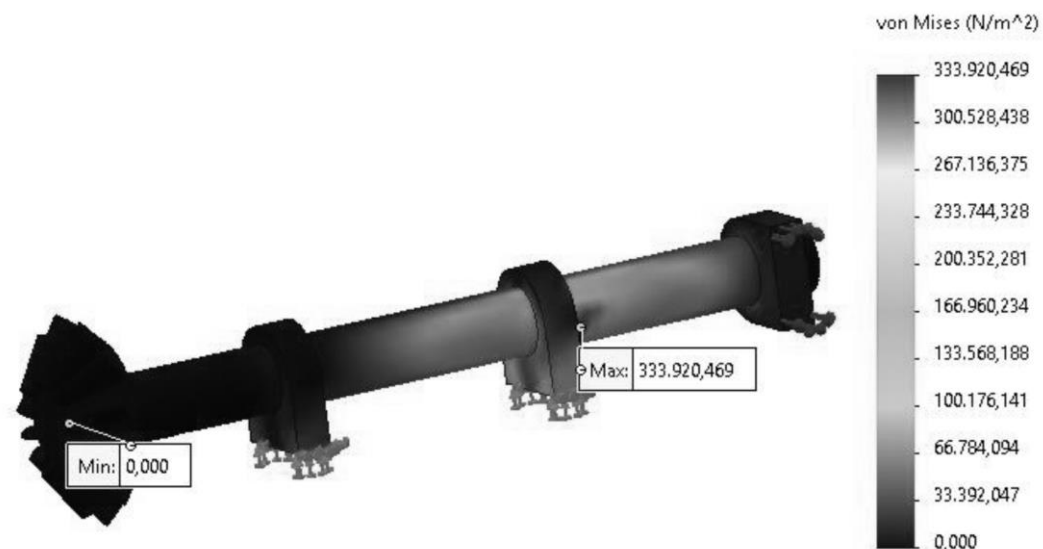
Gambar 4. Distribusi tegangan von Mises pada poros ulir hasil simulasi SolidWorks
