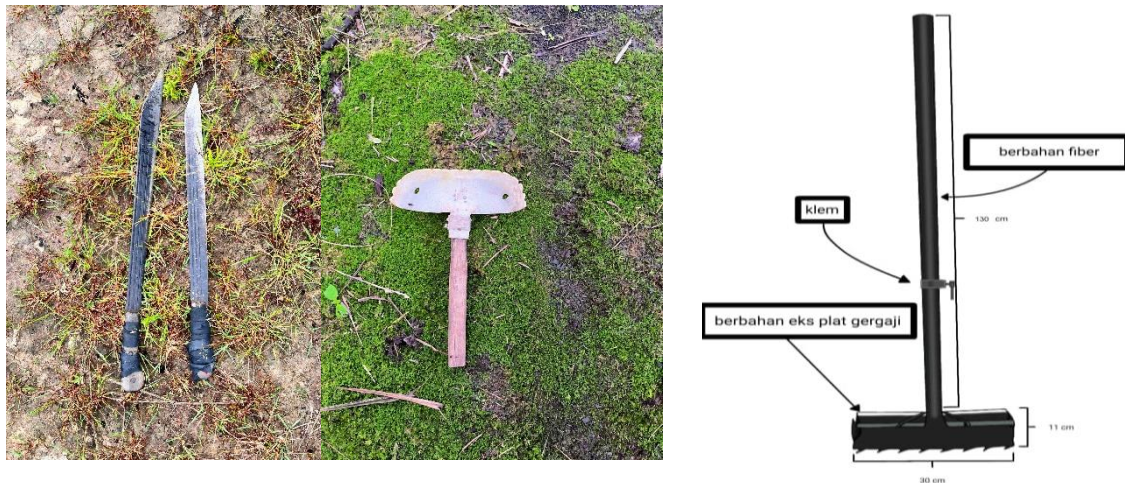
Gambar 1. Alat Garukan Piringan Sebelum (kiri) dan Sesudah (kanan) Modifikasi Penelitian pengembangan alat GARUKSA dilakukan dalam beberapa tahap:
