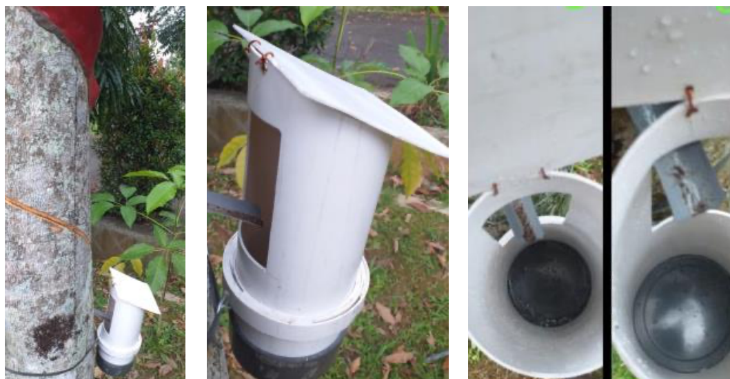
Gambar 1. Desain mangkok sadap modifikasi pada tahap awal penelitian (Perlakuan D)
