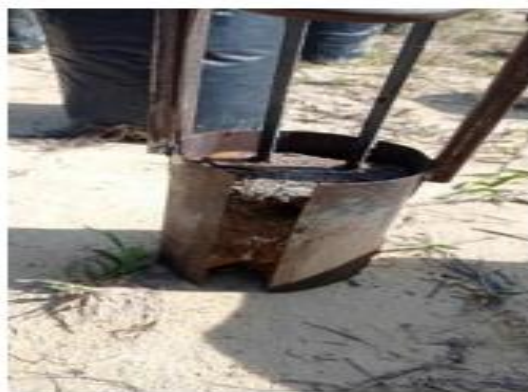
Gambar 10. Tanah yang terangkat sesuai dengan ukuran alat
