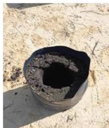
Gambar 12. Pengukuran kedalaman daya dorong alat T-PLANT yaitu 20 cm
