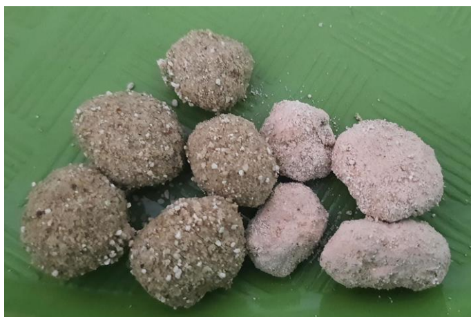
Gambar 1. Bentuk pupuk urea yang telah dilapisi dengan zeolit. Urea yang dilapisi zeolit aktif menunjukkan warna yang lebih gelap.
